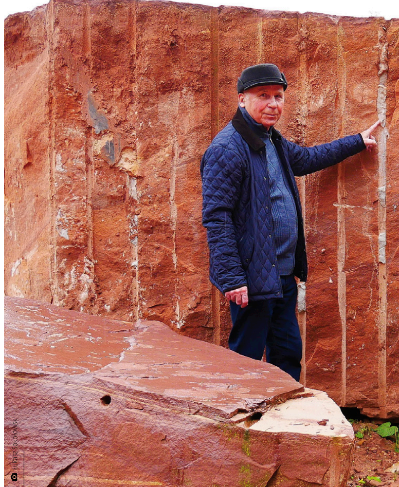
Jan Kłosowski i Marian Sobura w Kopalni Tumlin-Gród przy bloku skalnym odspojonym wapnem niegaszonym
